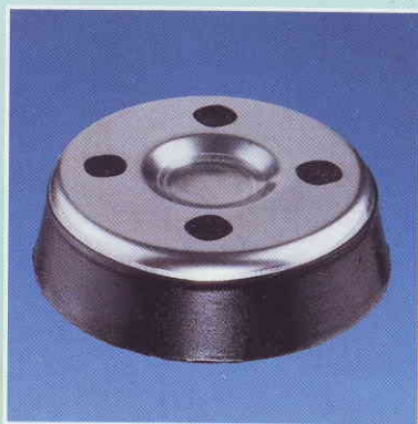
A 100 aus Lucobit Abdeckblech V2A Tragkraft 250 kp (stat. u. dynamisch)
