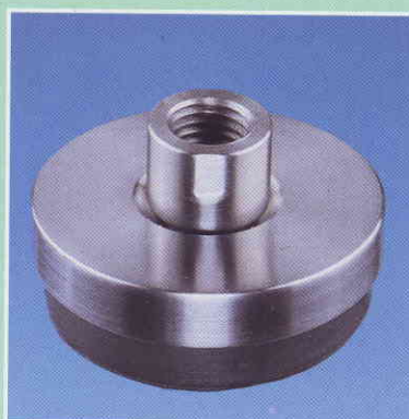
E 80 aus Baypren Abdeckblech ST 37 verzinkt Tragkraft 1500 kp (statisch/dynamisch)
